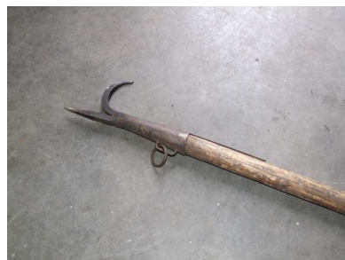
Trhací hák - používá se k rozebrání konstrukce zasažené požárem (např. střechy)
