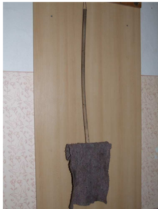
Tlumice - používá se k likvidaci malého požáru na rovné ploše
