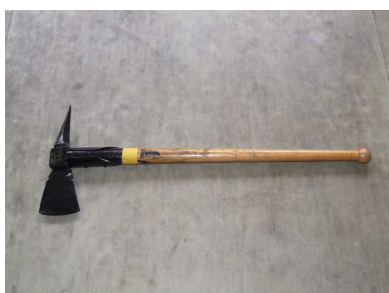
Sekera - použití jako u trhacího háku, případně jí lze např. rozbít dveře, které nejdou otevřít
